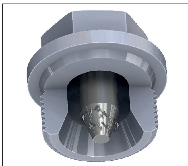
Fig. 2 As partículas ferromagnéticas se acumulam no cone do funil
